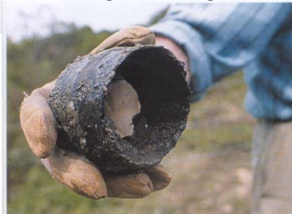
Bild 6.- Eiserner Deichelring, gewulstete Verbindungsmanschette zweier Holzrohre.
